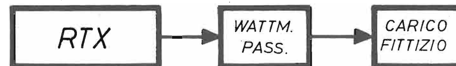
Fig. 1 - Questo schema di tipo a blocchi interpreta il modo di impiego del carico fittizio resistivo descritto nel testo. Il wattmetro passante va inserito fra il trasmettitore ed il carico che sostituisce l'antenna radiante.
